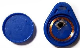
Abbildung 4 Ein geöffneter 13,56 MHz Tag.
