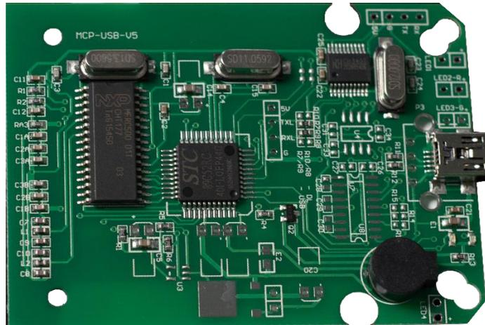
Abbildung 6 Die Vorderseite eines geöffneten RFID-USB-Readers.
