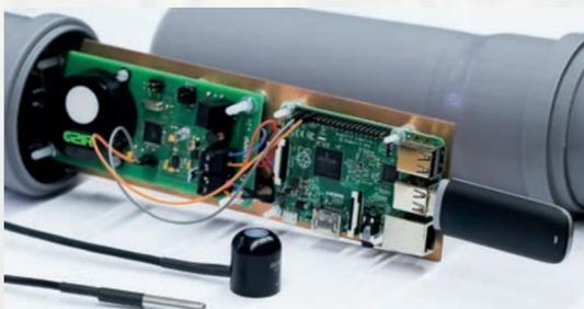
Fertige Messstation im Gehäuse
