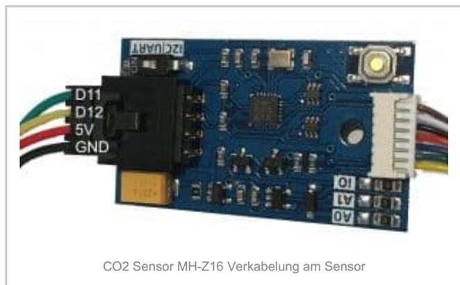
CO2 Sensor MH-Z16 Verkabelung am Sensor
