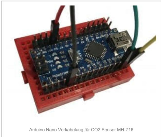
Arduino Nano Verkabelung für CO2 Sensor MH-Z16
