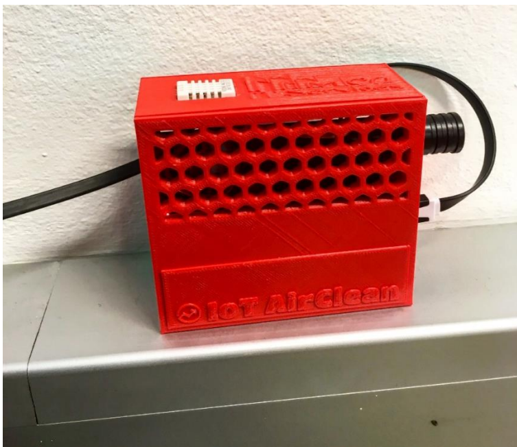
Abbildung 16: 3D Druck - finale Version der SensorBox
