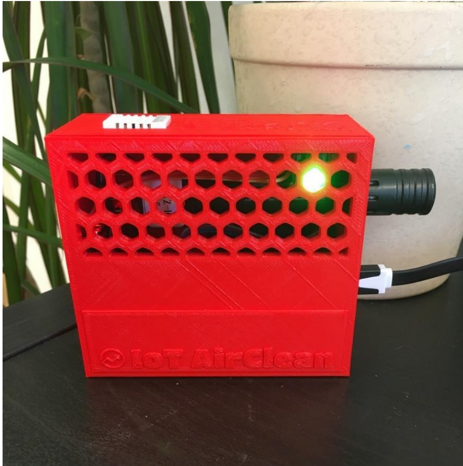
Abbildung 17: Usability Erweiterung einer RGB LED der SensorBox
