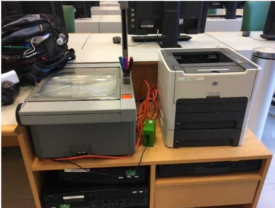
Abbildung 7: Mobile Teststation und die SensorBox
