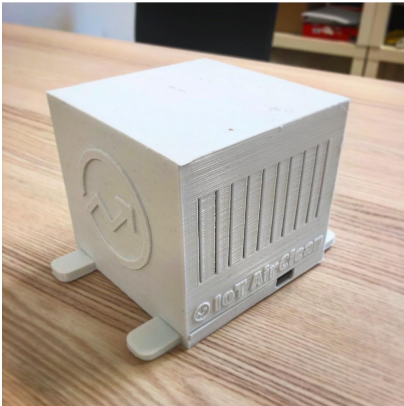
Abbildung 11: 3D Druck - IoT AirClean Cube
