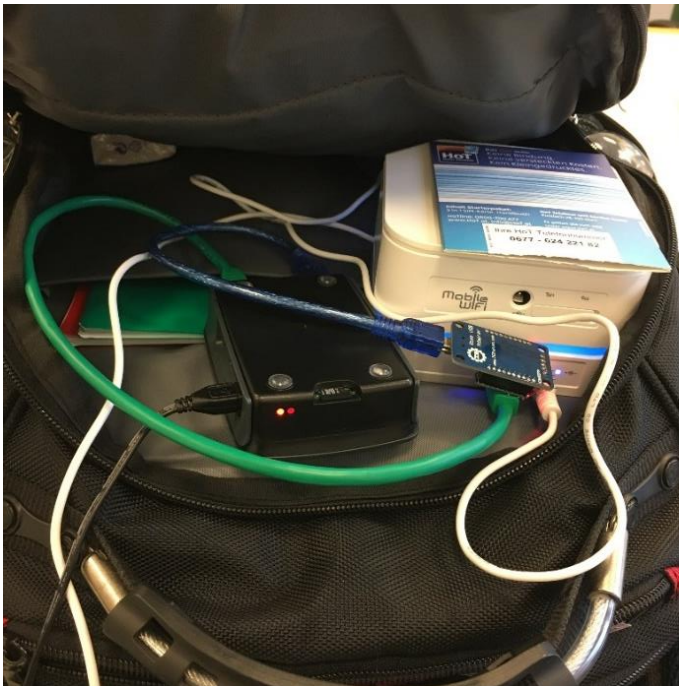
Abbildung 6: Mobile Teststation mit Mobile Internet
