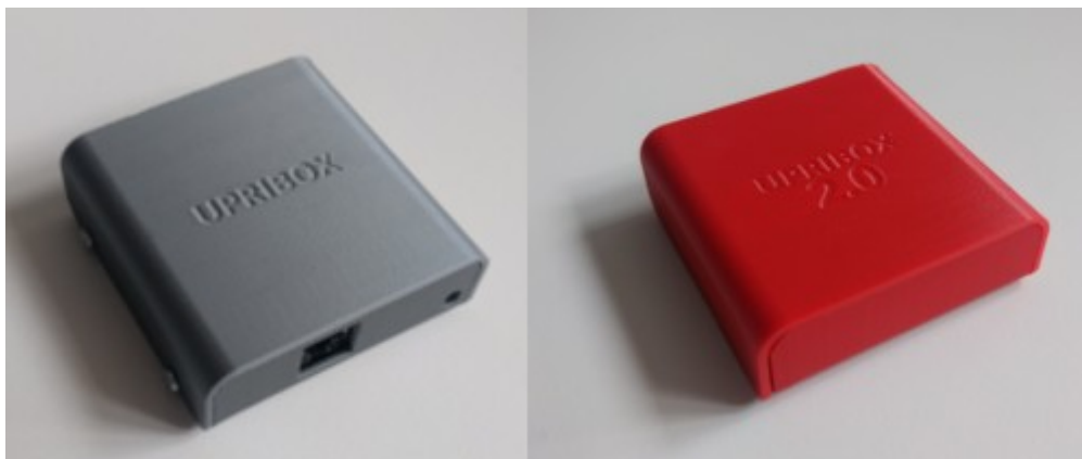
Abbildung 1: 3D-gedruckte Gehäuseprototypen für den BananaPi M2+
