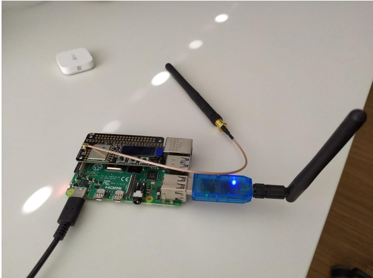
Abbildung 2 - LoRaBridge „Bridge“ Einheit auf einem Raspberry Pi 4 Computer implementiert
