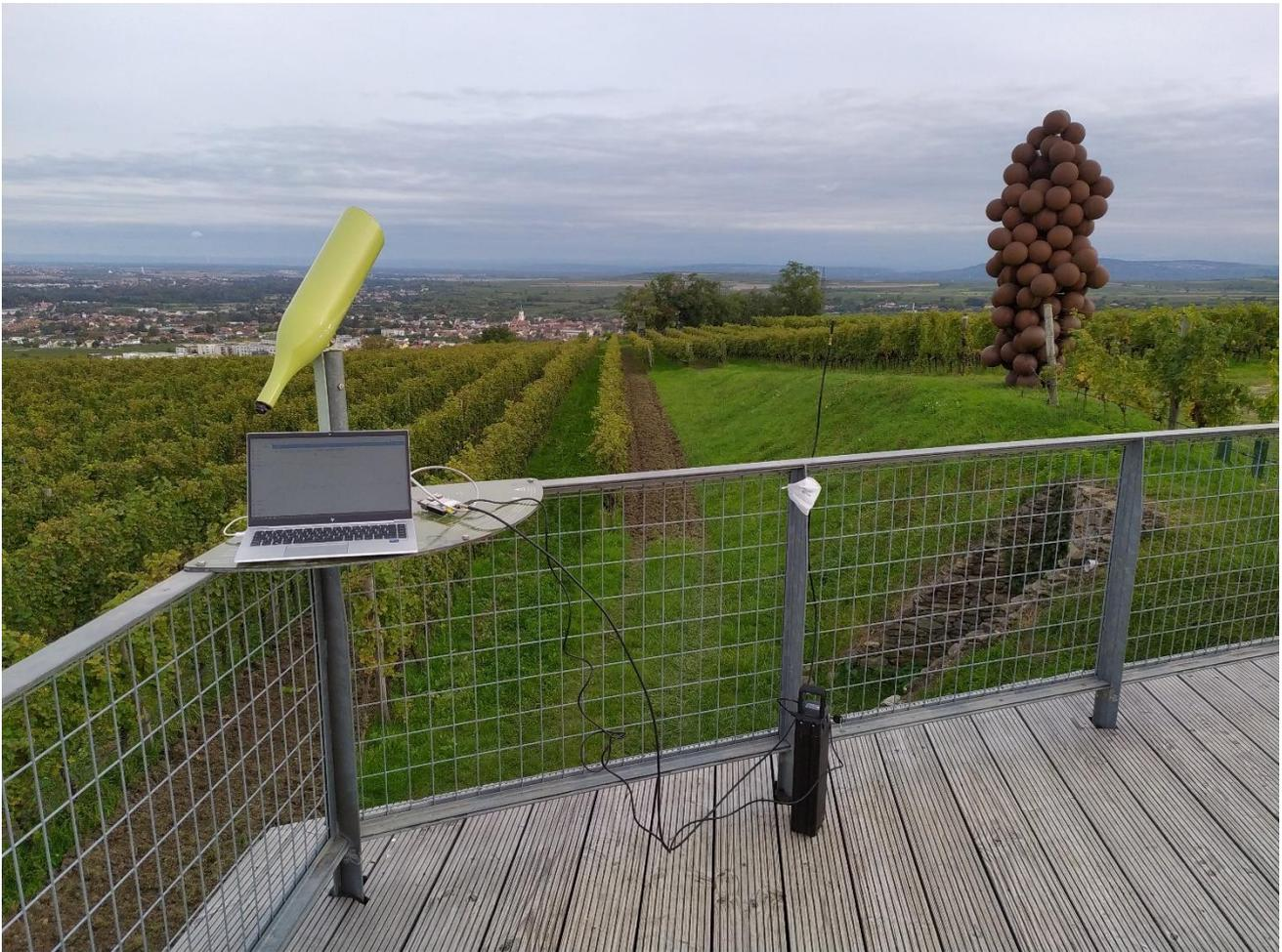
Abbildung 6 - LoRaBridge Gateway in Use-Case "Weinbauer"
