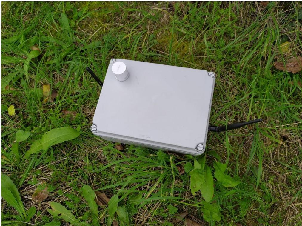
Abbildung 4 - LoRaBridge Bridge Einheit in wetterfestes Gehäuse
